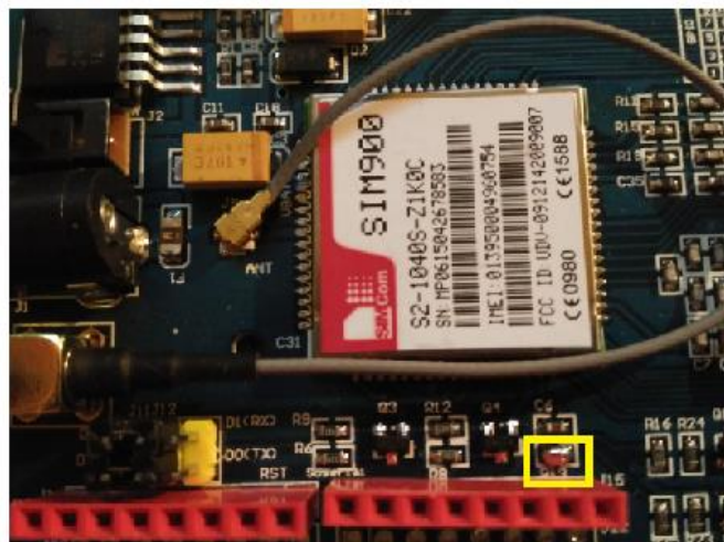
Figura 55: Pines a unir para habilitar el encendido por software de la SIM900. Fuente: (prometec.mx, 2019)
